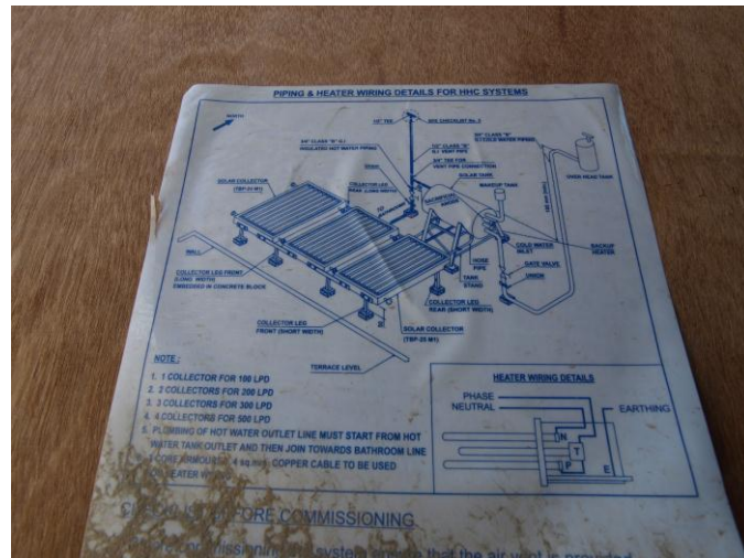
Figure 2 - Schéma de l'installation solaire eau chaude
